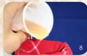
Giet de appelmoes uit het bekertje waaraan je CANNAZYM hebt toegevoegd over in de trechter (met daaronder een gecodeerd bekertje!). Kijk hoeveel vocht er door de filter druppelt. Wacht ongeveer een kwartier; het meeste vocht is er dan doorheen gelopen. Maak de vuile theedoek goed schoon als je de proef wilt herhalen. Dit geldt ook voor het bekertje waar alleen water is toegevoegd (de blanco).
